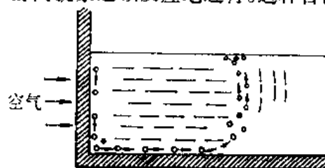
图 1-18 晶体比熔体重合金在凝固初期的结晶行为
