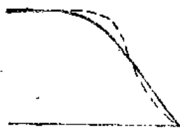
图13-7 C_p 较大, 做成凹形易产生角点
