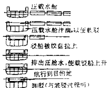
图 7-4 浮进浮出型原理图
