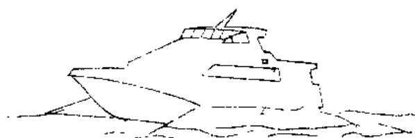
图 10-3 穿浪型高速双体船示意图
