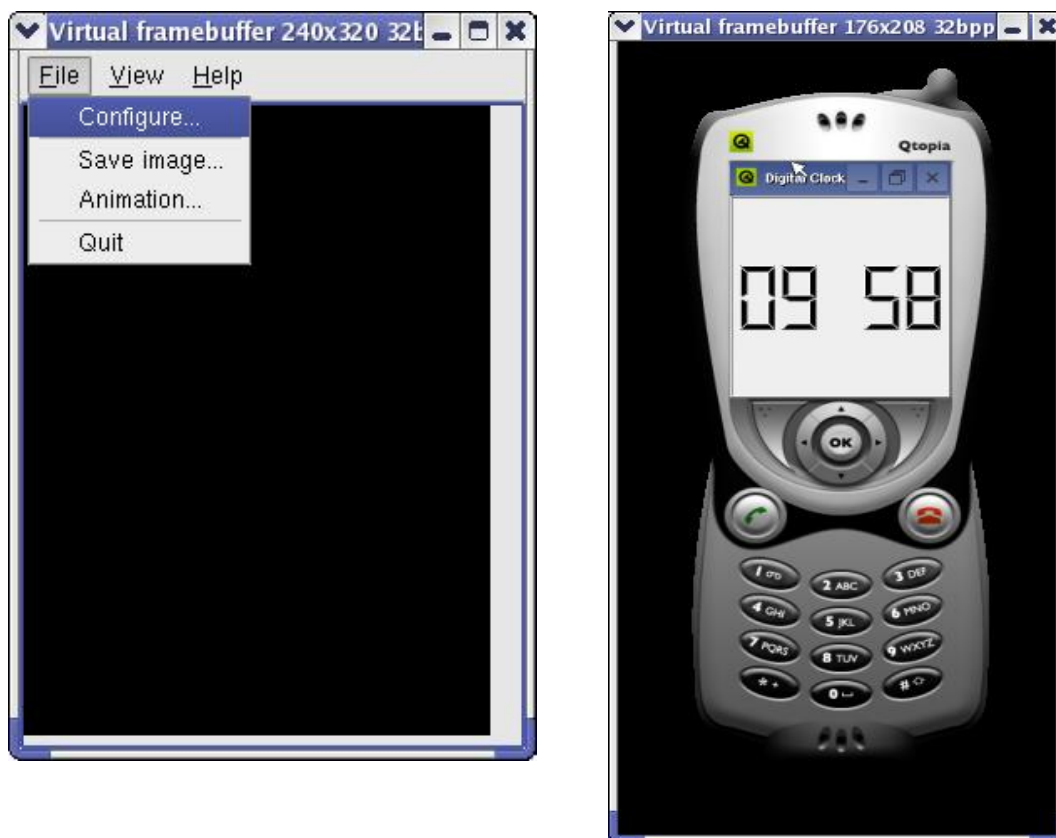
图 12.4 修改 qvfb 的配置及修改之后的效果
